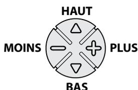
**Réglez l'heure réelle** en utilisant les signes «PLUS» et «MOINS». En tenant le signe appuyé, l'heure change rapidement. En tapant sur le signe, l'heure avance par étapes. Une fois l'heure réelle obtenue, utilisez la flèche vers le bas pour passer à l'étape suivante.
