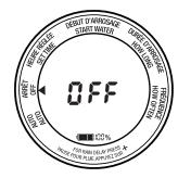
**NOTA:** El ajuste del temporizador en el modo **OFF** (desconectado) desactiva todas las zonas de riego. Para desactivar una o más zonas específicas, utilice el **botón del cursor** para pasar al ajuste **HOW LONG** (duración). Asegúrese de estar ajustando la zona de riego deseada, usando el botón **ZONE** pie la duración **HOW LONG** en "0". Para reactivar la zona, ajuste la duración **HOW LONG** nuevamente en la duración de riego deseada.
